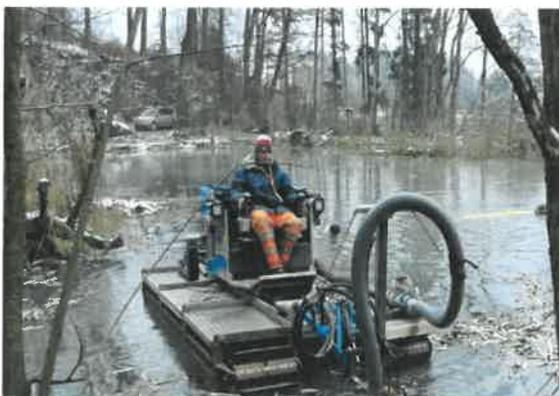
Abb. 3.5 Amphibienfahrzeug, das den Schlamm im Teich in Oftringen entfernt (7.12.2017/ SKK)
